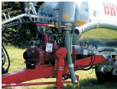
Vakuumpumpe - mit Kreiselpumpe kombiniert, dadurch bis 30 m Verteilbreite erreichbar.
